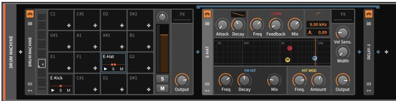
Was Sie nun sehen, ist die Drum-Chain selbst, die wiederum eine Device-Chain ist. Die beiden Quadrate in der Chain-Vorschau stellen die **E-Hat**- und **Delay-1**-Devices dar.
