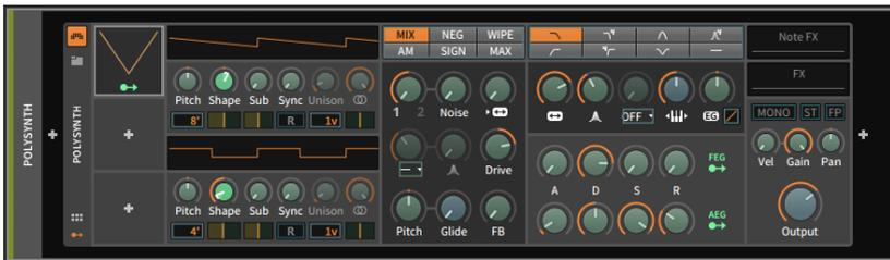
Da Nested-Devices von Top-Level-Devices moduliert werden können, werden polyphone Modulationsquellen in der Regel summiert und stehen als monophone Signale zur Verfügung. Als Beispiel sehen wir hier das **FEG**-Modul, dessen monophones Signal einen **De-esser** moduliert.
