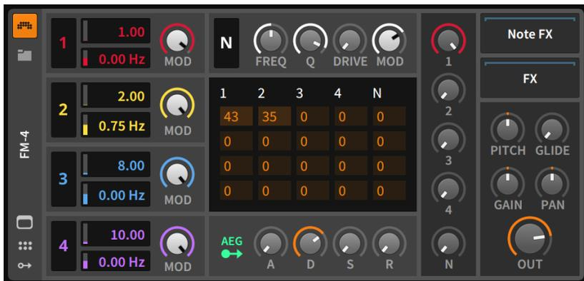
Auf der linken Seite sind vier identische Bereiche, in denen sich die vier Sinus-Oszillatoren des Instruments befinden. Oszillator 1 ist am oberen Rand, darunter sind die Oszillatoren 2, 3 und 4.
