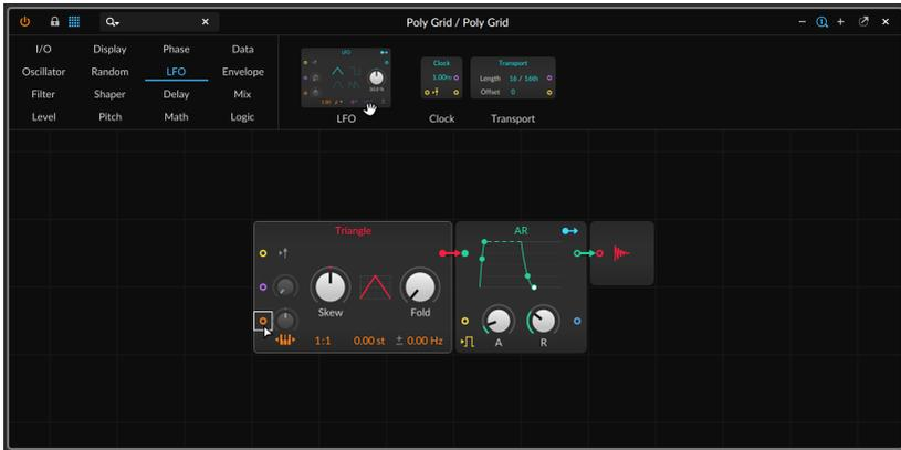
Wenn Sie ein Modul auf einen nicht verbundenen Ein- oder Ausgang ziehen, wird ein passender Anschluss des Moduls damit verbunden.
