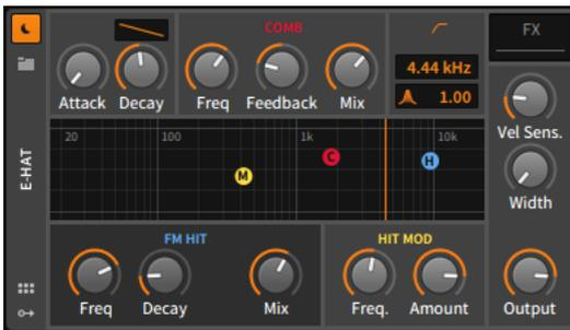
Der Bereich oben links besteht aus den Reglern für die *Attack*- und *Decay*-Zeit der AD-Hüllkurve, zusammen mit einem Regler für die Form des Decay-Bereichs. Diese Hüllkurve formt das Ausgangssignal des gesamten Instruments.
