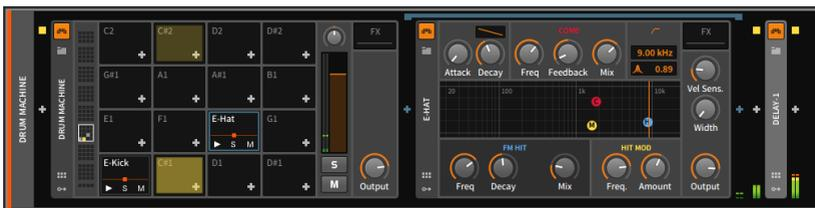
Somit werden alle Audiosignale, die aus der **Drum Machine** kommen, durch das **Delay-1** geschickt.
