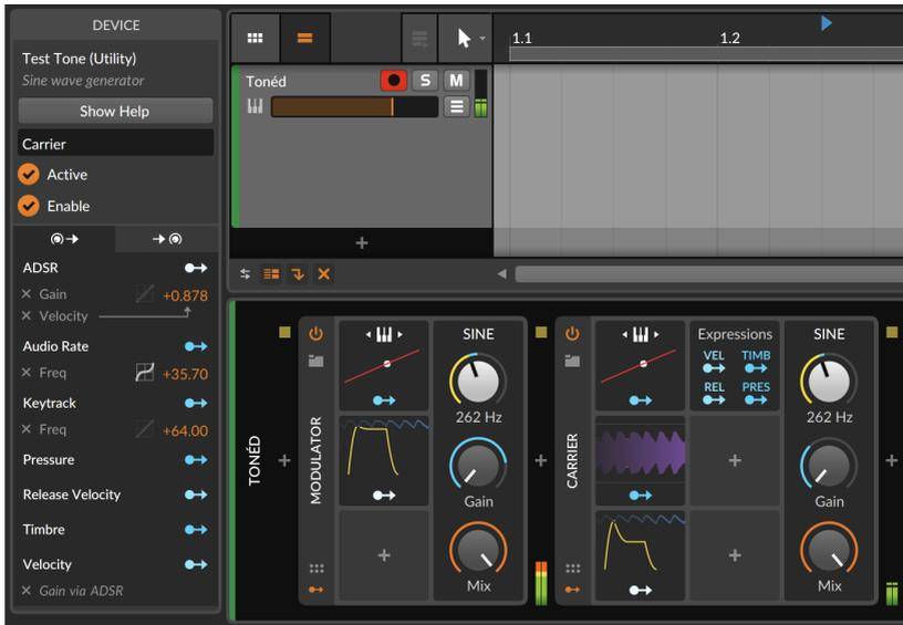
Die zwei neuen Einträge im **Inspektor-Panel** zeigen an, dass Modulationssignale skaliert werden. Falls der **ADSR** noch einen weiteren Parameter modulieren soll, wird diese neue Verbindung nicht durch den *Vel(ocity)*-Parameter skaliert, da Skalierungen immer für jede Modulation einzeln eingestellt werden.
