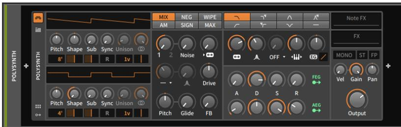
Hier sind zwei eingebauten Modulationsquellen verfügbar, die beide Module innerhalb des **Polysynth** sind. Die Filterhüllkurve (Filter Envelope Generator, kurz **FEG**) ist fest der Cutoff-Frequenz des Filters zugewiesen, genau wie die Lautstärkehüllkurve (Amplitude Envelope Generator, kurz **AEG**) die Lautstärke des Instruments steuert.
