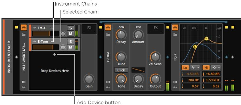
Die Chains in diesem Device werden *Instrument-Chains* oder Layer genannt. Jede von ihnen ist eine komplette Device-Chain, aber im Gegensatz zur **Drum Machine** gibt es hier keine vorgegebene Anzahl an Chains. Deshalb gibt es auch nur einen *Add-Device-Schalter* in der Hauptanzeige des **Instrument Layers**, mit dem jedes neue Device auf einer neu erstellten Instrument-Chain platziert wird. Wenn genug Instrument-Chains hinzugefügt worden sind, können Sie durch die Liste vertikal scrollen.
