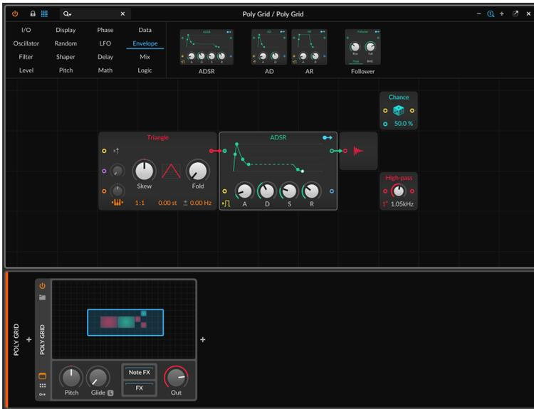
In der obigen Abbildung sehen wir das Resultat: Das **AR**-Modul wurde tatsächlich gegen das **ADSR**-Modul ausgetauscht. Alle kompatiblen Parameter wurden übertragen sowie alle relevanten Patchverbindungen und alle Verbindungen zu Modulatoren neu verbunden.
