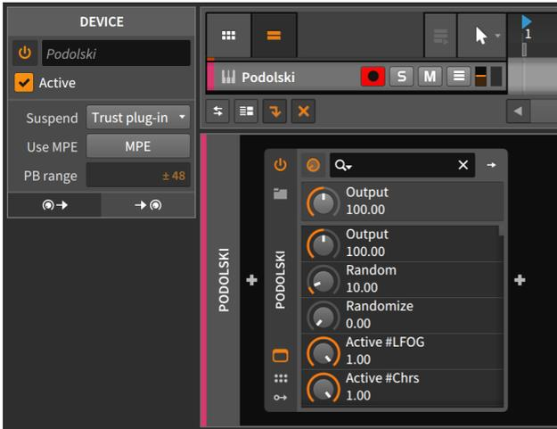
Die Option *Suspend* legt fest, auf welche Art und Weise Bitwig Studio entscheidet, dass ein Plug-in nicht mehr benötigt wird und vorübergehend deaktiviert werden kann. (Wenn dieser Fall eintritt, wird der Power-Schalter des Plug-ins zum Symbol eines Mondes und zeigt somit an, dass das Plug-in keine CPU-Leistung mehr verbraucht.) Sie können zwischen drei Optionen wählen:
